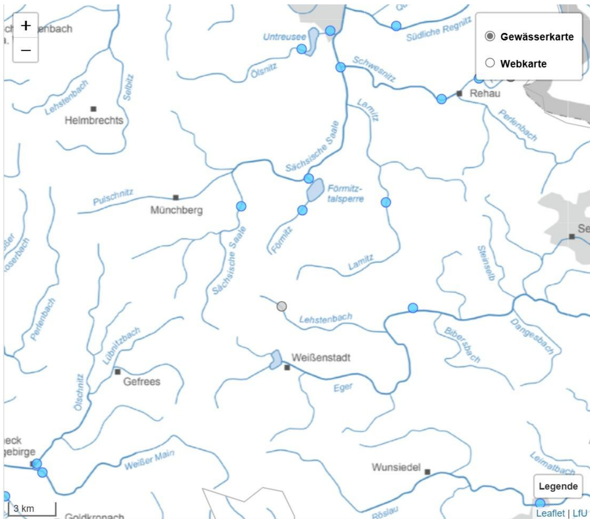
Abbildung 31: Fließgewässer und Abflussmessstellen (blaue Punkte) im Bereich Zell. Quelle: gkd Bayern
